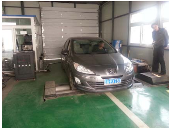
图3 国IV汽油车 ASM 法排放污染物检测现场
