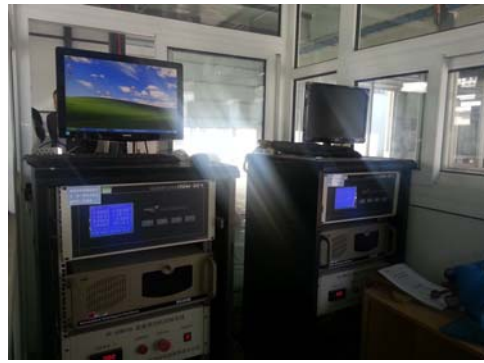
图2 五气体分析仪及控制系统
